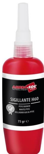
**H60 ÉTANCHÉITÉ AU TEFLON (PTFE)** - Convient pour l'étanchéité des raccords filetés pour gaz, air comprimé, eau, huiles, hydrocarbures, d'oxygène et de nombreux produits chimiques. Remplace le chanvre, les rouleaux et joints en téflon. Assure une très grande élasticité et une imperméabilité. Moyenne-faible résistance à l'arrachement.
