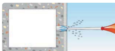
2. Nettoyer le perçage à l'aide d'un écouvillon et d'une soufflette
