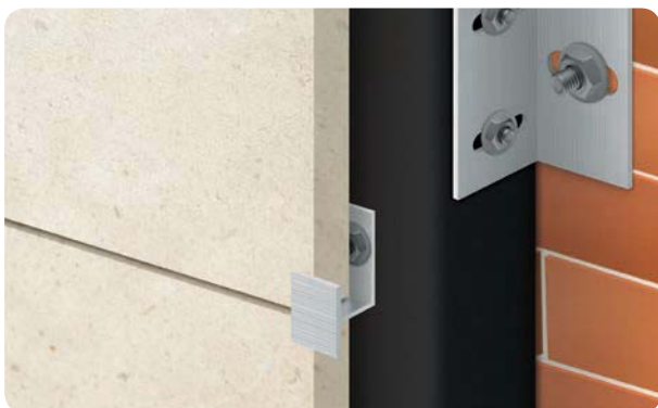
Fixation à agrafe visible
