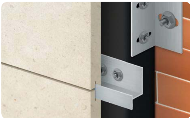
Fixation à agrafe invisible
